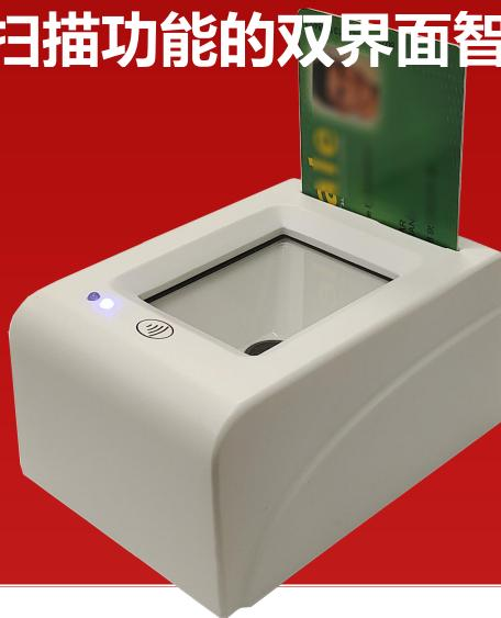
集成二维码扫描、接触式 (ISO/IEC 7816) 、非接触式 /NFC (13.56 MHz) 技术和可扩展 SAM 加密认证，多功能读卡器
